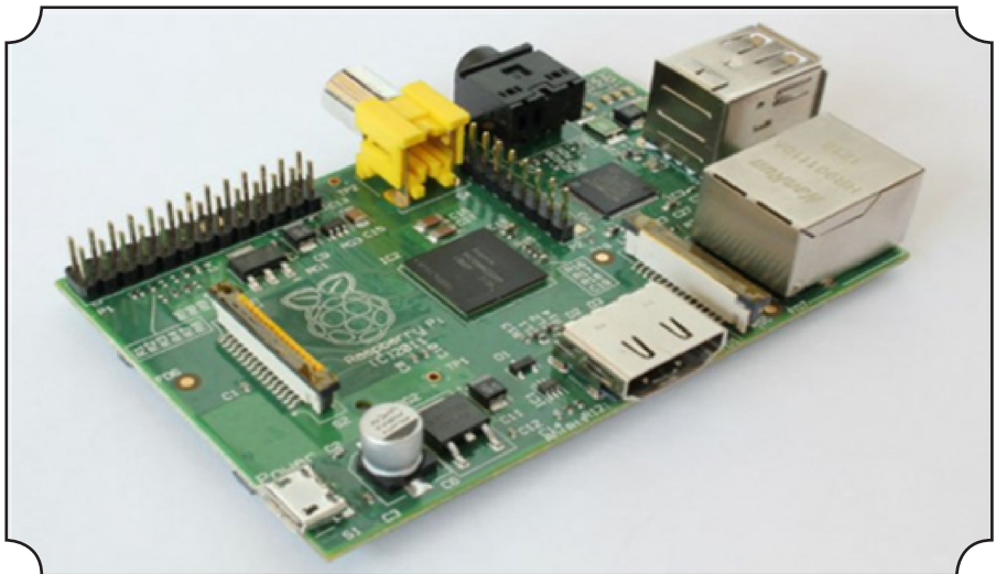
5 වන රූපය - රැස්පබේරි Pi, ණය කාඩ්පතේ ප්‍රමාණයේ එක පුවරු පරිගණකය
